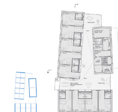
Schema Tragstruktur 1:500 Trennwände tragend, Schallschutz
