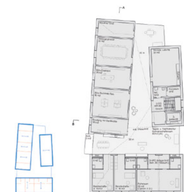
Schema Tragstruktur 1:500 Trennwände flexibel einbaubar
